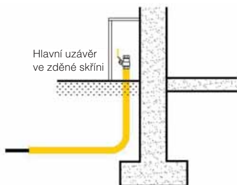
Budova bez sklepa. Hlavní uzávěr před budovou v plynoměrné skříni.
