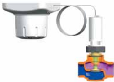
Teplota v místnosti pod požadovanou hodnotou, ventil uzavřen
