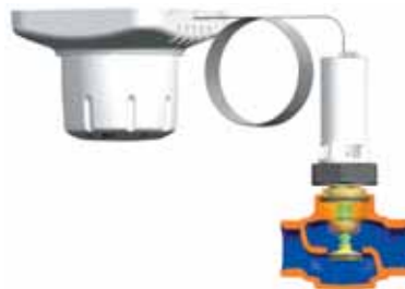
Teplota v místnosti nad požadovanou hodnotou, ventil otevřen
