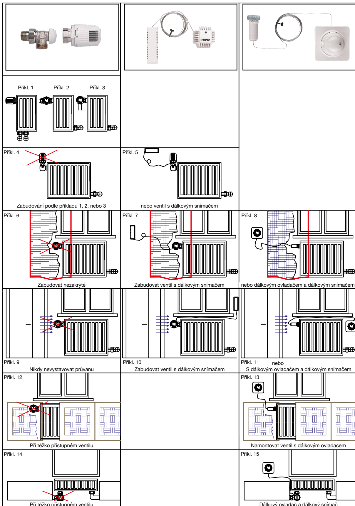
Obr. 8-21 Uspořádání prostorových snímačů nebo termostatických hlav
